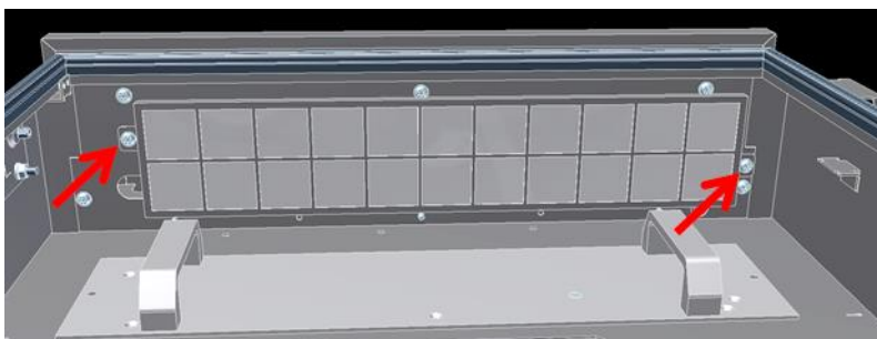
Figura 35: smontaggio filtro dell'aria (vista anteriore dal basso)
