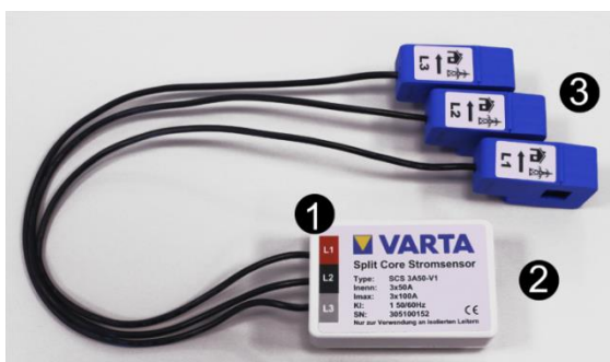
Figura 14: Sensore di corrente VARTA Split Core
