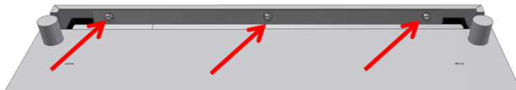
Figura 37: dadi del coperchio quadro (vista inferiore dal basso)
